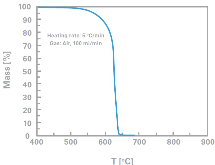
**Figure 2.** TGA of Thermax<sup>®</sup> N990
